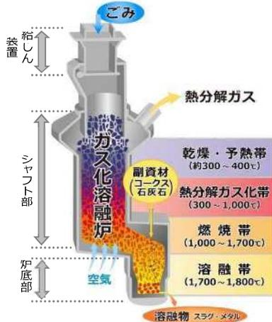
シャフト炉式ガス化溶融炉は「ごみ」投入に合わせて副資材（コークス、石灰石）を投入します。溶融炉では「ごみ」処理と同時に「ごみ」中の灰分を高温（1,700～1,800℃）溶融します。炉内は高温還元雰囲気にとられ、有害な重金属成分は揮発ガスとして後流側へ移行し、炉底より取り出される溶融物（溶融スラグ）は天然砂と同等の品質となります。
